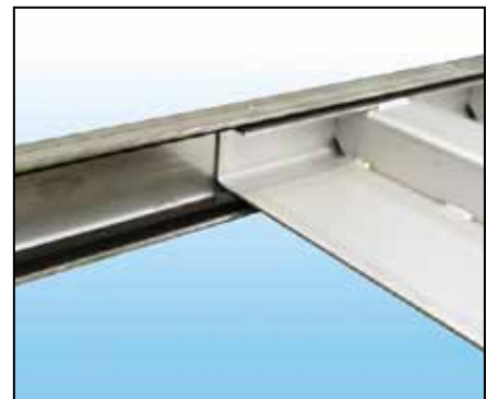
Spjældpladen styres af fire PEHD skinner. Dette er medvirkende til at pakningen skånes.
