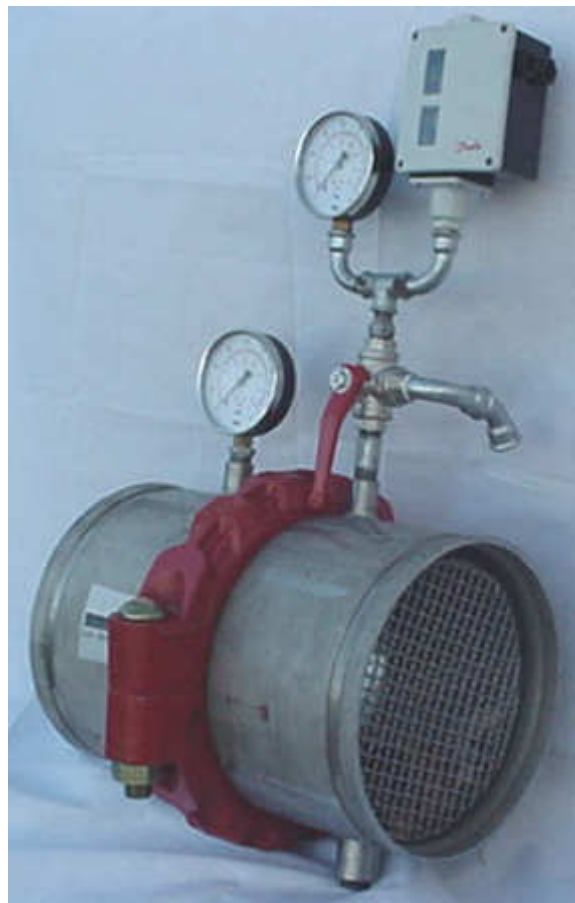
Bilden visar tryckfallssimulering monterad på stenfälla.
